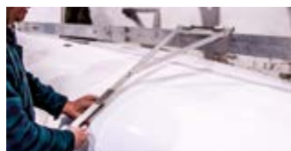
Разметка станций на корпусе
