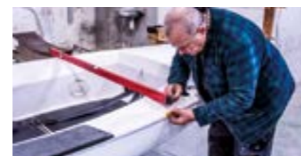
Измерение глубины кокпита на станции 2
