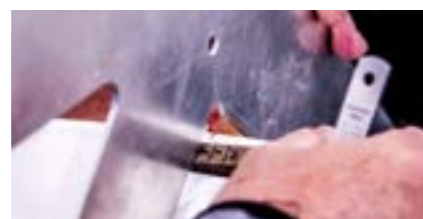
Калиброванный на 10 мм клин, используется для проверки щели между корпусом и шаблоном (должен быть менее 10 мм)
