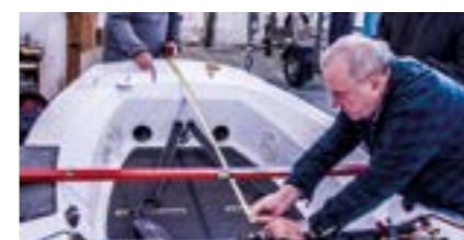
Измерение положения бимса погона
